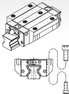
与MSR-E型具有相同断面尺寸，增加滑块的长度，并增加负荷滚柱数，提升整体的负荷能力。
