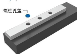
将螺栓孔盖放置沉头孔内
