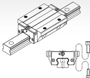
与SME-EB型具有相同断面尺寸，增加滑块的长度，并增加负荷滚珠数，提升整体的负荷能力。
