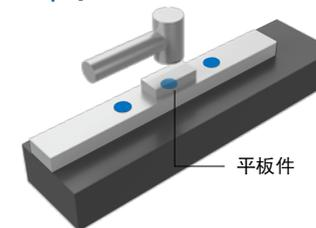
继续敲击螺栓孔盖，直到与滑轨上表面成同一平面
