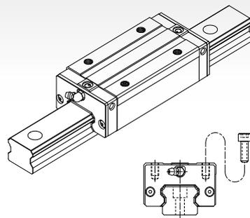
与SME-SB / SME-SV型具有相同断面尺寸，增加滑块的长度，并增加负荷滚珠数，提升整体的负荷能力。
