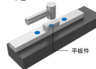
将一平板件放置螺栓孔盖上，以塑胶槌子垂直敲击平板件，使孔盖敲入螺栓孔内
