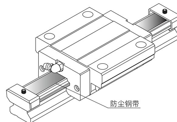
注: 为安装防尘钢带，滑轨需进行铣沟加工，而标准型防尘钢带不会增加组装后之滑轨高度。
