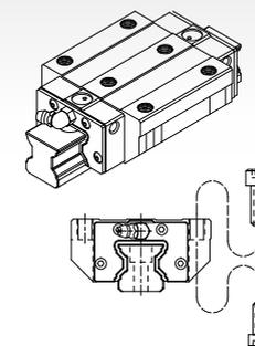
除了可从滑块的上面进行装配外，同时又适用于工作台无法开安装螺栓用贯穿孔的状况下，从滑块的底面往上进行装配。
