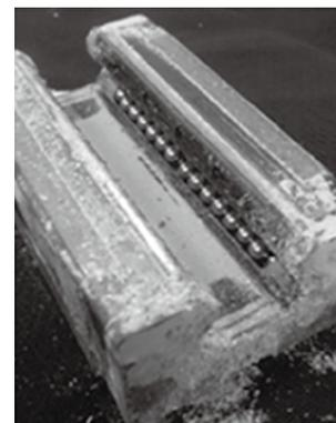
运行150KM后，滑块运行依然顺畅，且钢珠表面光滑；木屑皆被阻挡于刮油片及上防尘片外，极少数进入滑块内部，使整体运行顺畅，无造成严重影响。
