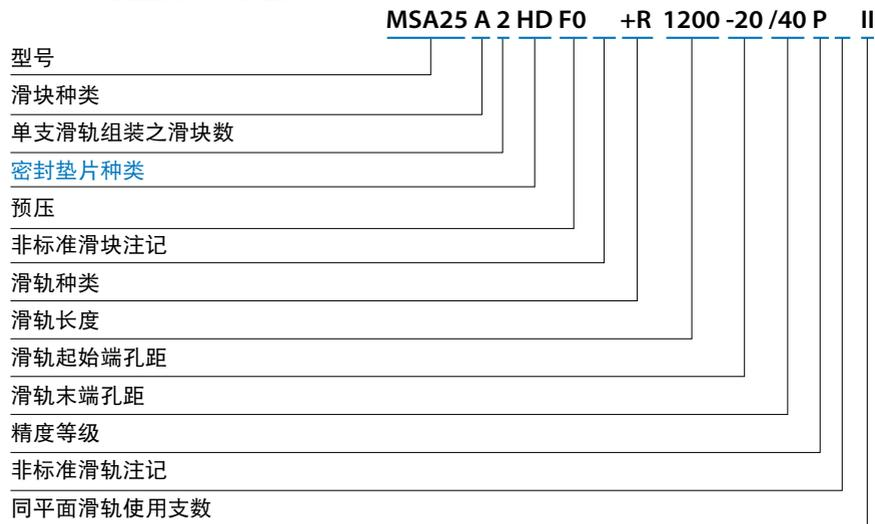
注: 适用规格有MSA15、MSA20、MSA25、MSA30、MSA35、MSB15、MSB20(A型、E型、S型)
