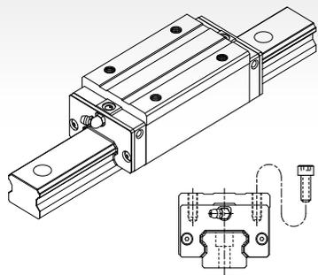
与SME-SA型具有相同断面尺寸，增加滑块的长度，并增加负荷滚珠数，提升整体的负荷能力。
