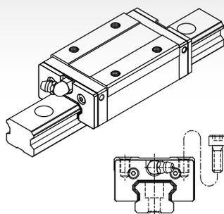
与MSB-TS型具有相同断面尺寸，增加滑块的长度，并增加负荷钢珠数，提升整体的负荷能力。
