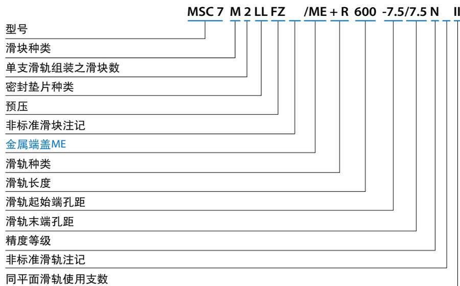
注: 适用规格有MSC7M、MSC7LM、MSC9M、MSC9LM、MSC12M、MSC12LM、MSC15M、MSC15LM、MSD12M、MSD12LM、MSD15M、MSD15LM。
